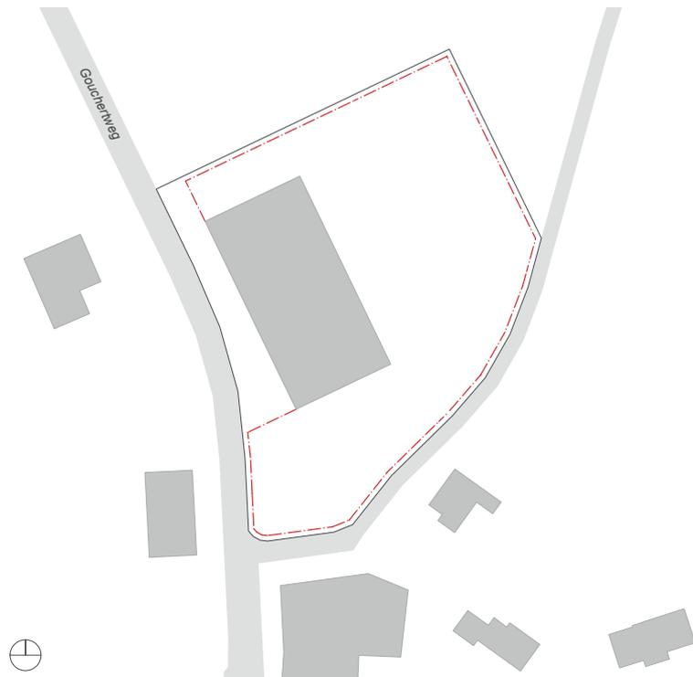
Schematische Darstellung einer möglichen Umzäunung (rote Linie). Der Zaun darf nicht entlang des Gouchertwegs vor der Fassade durchgezogen werden.
